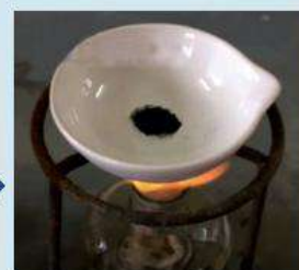
▲ Nhiệt phân \text{Cu}(\text{OH})_2 tạo thành \text{CuO}
