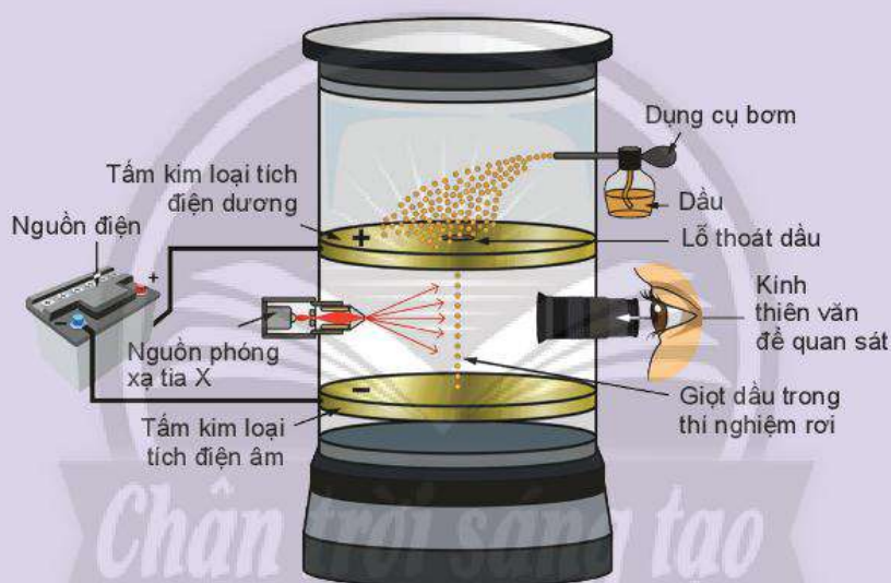
▲ Thí nghiệm giọt dầu của Millikan
