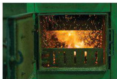
(c) Khi đốt than trong lò, đậy nắp lò sẽ giữ than cháy được lâu hơn.
