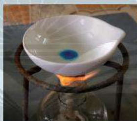
▲ Nhiệt phân \text{Cu}(\text{OH})_2 tạo thành \text{CuO}
